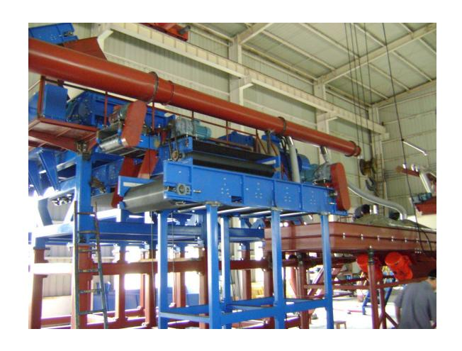
THIS PICTURE ABOVE SHOWS OTHER DESIGN FEATURES IN THE RASPER SYSTEM WHICH INVOLVE A MAGNETIC SYSTEM AND SCREENING SYSTEM AFTER THE RASPERS..
